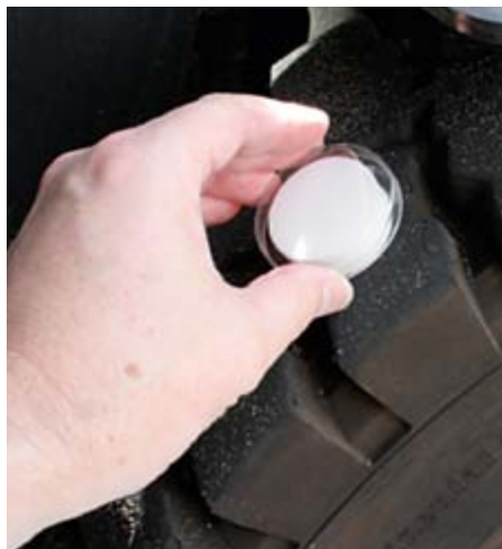
Abklatschprobe vor und nach dem ProfilGate® Reinigungsfeld Taking probes before and after passing the ProfilGate® field
